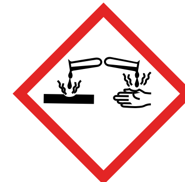
Corrosion: skin corrosion, serious eye damage การกัดกร่อน: การกัดกร่อนของผิวหนัง ความเสียหายแก่ดวงตาอย่างรุนแรง
