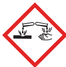
腐蚀 (腐蚀: 皮肤腐蚀、眼睛严重损伤、对金属的损伤)
